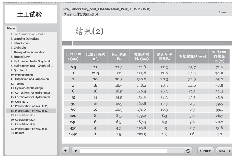
图 5 土体分类第三部分测试数据及其相关计算表格（以比重计试验为例）
