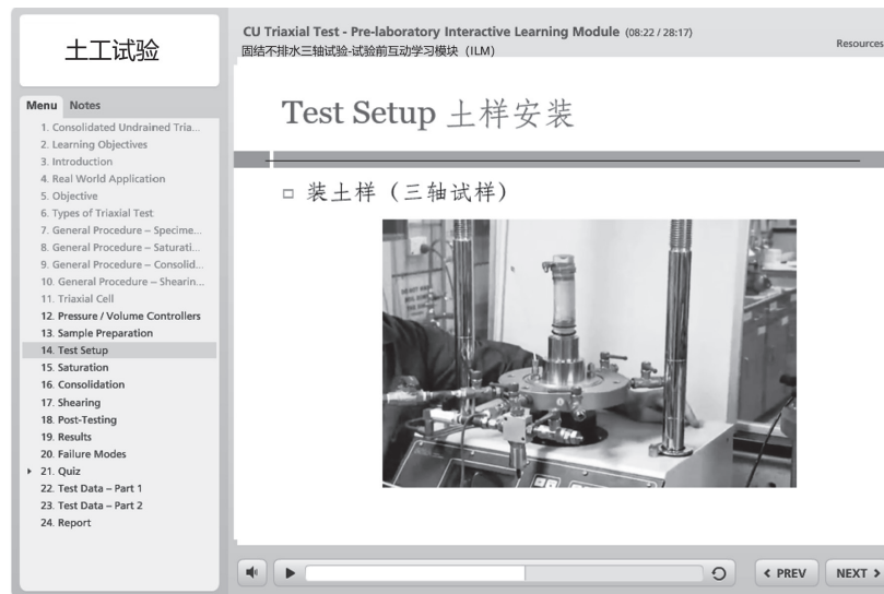
图 4 固结不排水三轴试验视频（介绍实验设备及其操作）
